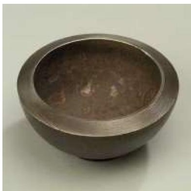
Figure 1 : Photo d'une coquille brut de forgeage.
