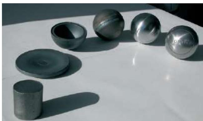
Figure 4 : Gamme de fabrication.
