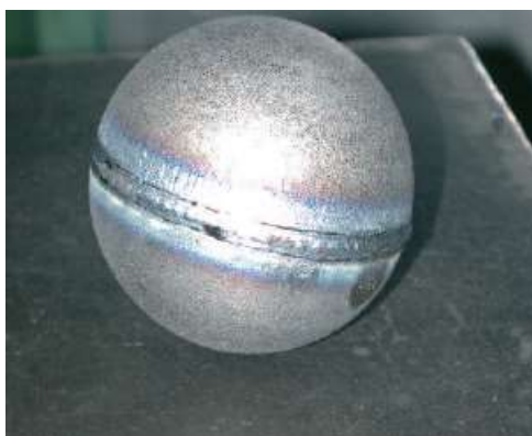
Figure 6 : Illustration de deux hémisphères assemblées.
