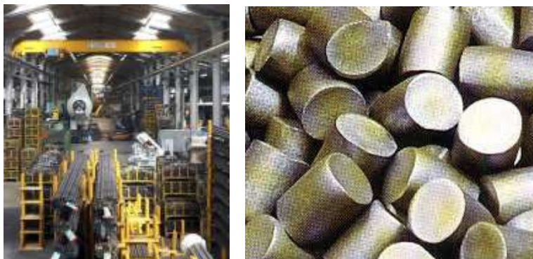
Figures 2 et 3: Barres de diamètre 40mm utilisées et lopins issus de l'opération de cisailage.
