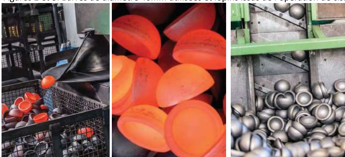
Figure 4 : Illustrations du procédé d'estampage – matriçage.
