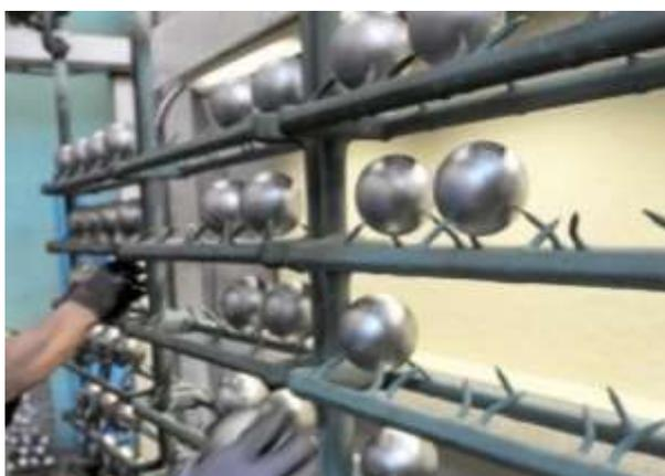
Figure 2 : Support en vue des traitements de surface.
