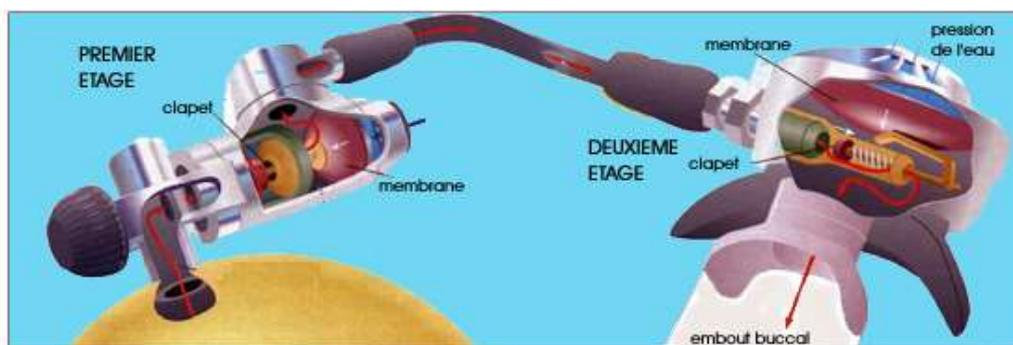
**Figure 3** : fonctionnement d'un détendeur.
