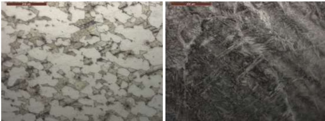
Figure 5 : Structure métallurgique de la vis. Figure 6 : Structure métallurgique de la sphère.
