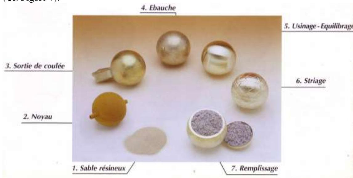
Figure 7 : Principales étapes de fabrication d'une boule lyonnaise [2]
