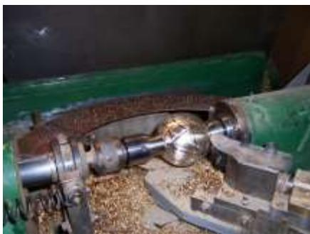
Figure 9 : Opération de finition : striage [4]
