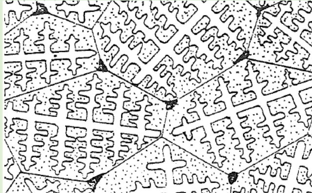
Figure 6 : Dendrites de solidification : photo 3D obtenu au microscope électronique à balayage et représentation schématique 2D des grains de solidification.
