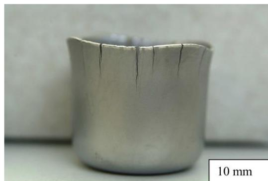
Figure 6 : Rupture différée dans l'acier austénitique 301LN après emboutissage profond d'un godet à fond plat. [BERRA 2007]
