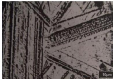
Figure 3 : Structure hexagonale / Martensite d'écroissage.
