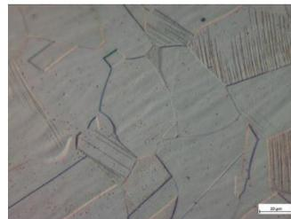
Figure 1 : Réseau C.F.C. de l'austénite et structure métallurgique associée. (Photo Struers)
