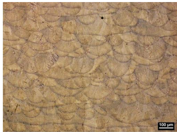
Figure 13 : Structure métallurgique à l'état brut de FA. [10]
